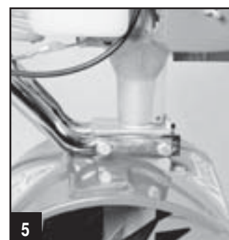
ILUSTRÁČNÍ OBRÁZEK UKAZUJE MOTOR, KTERÝ JE SPRÁVNĚ OSAZEN NA KRYTU ŠNEKOVÉHO PŘEVODU
