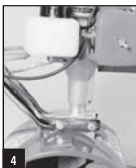
ILUSTRÁČNÍ OBRÁZEK UKAZUJE MOTOR, KTERÝ NENÍ SPRÁVNĚ OSAZEN NA KRYTU ŠNEKOVÉHO PŘEVODU
